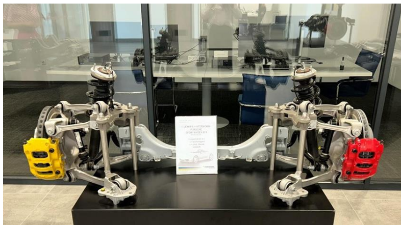
Slika 1: Pozicije ugradnje lagera u zadnje vešanje Porsche-a 911
